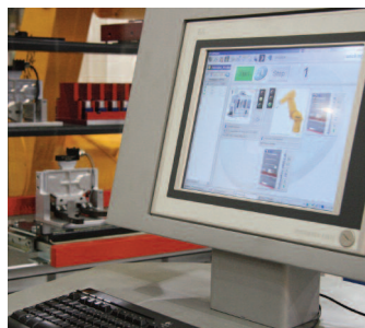
Über das Zellen-Management-System wird der ‚funmaker 160‘ (einschließlich 6-Arm-Roboter) via TouchScreen programmiert und gesteuert.
