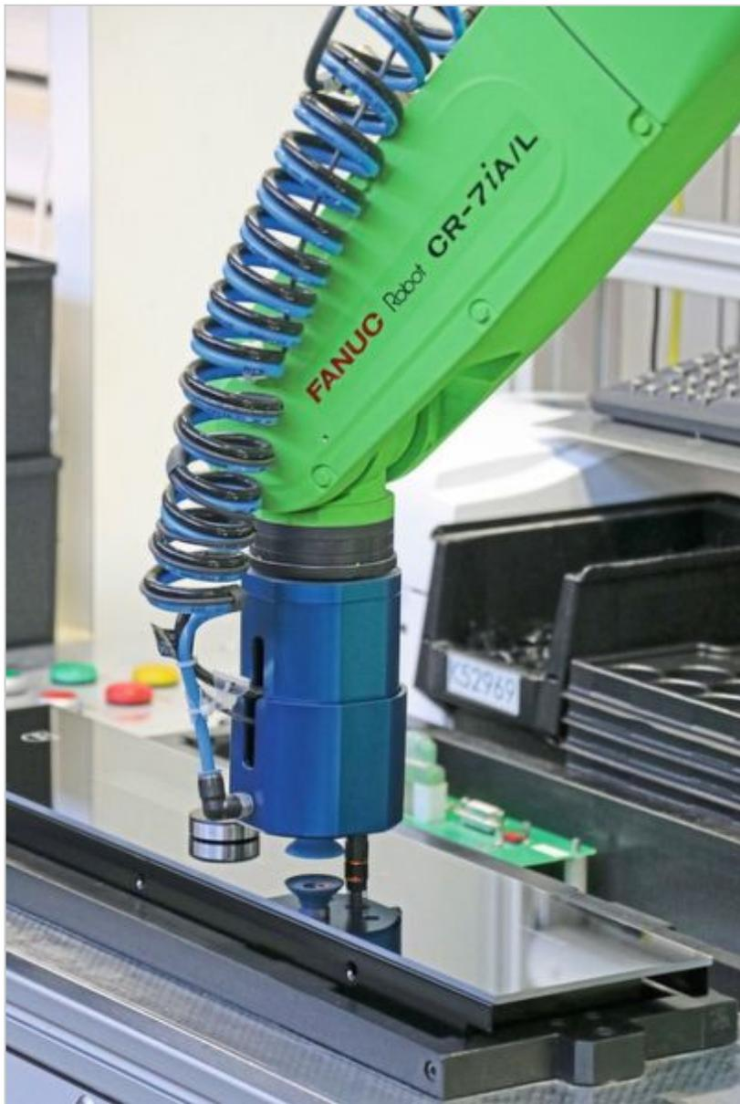
Der kollaborative Fanuc-Roboter CR-7iA/L ist ein 6-Achsen-Roboter mit einer Reichweite von 911 mm. Er bewältigt eine maximale Traglast von 7 kg und eignet sich optimal, um leichte manuelle Aufgaben zu übernehmen, die ermüdend und monoton sind. (Fanuc)
