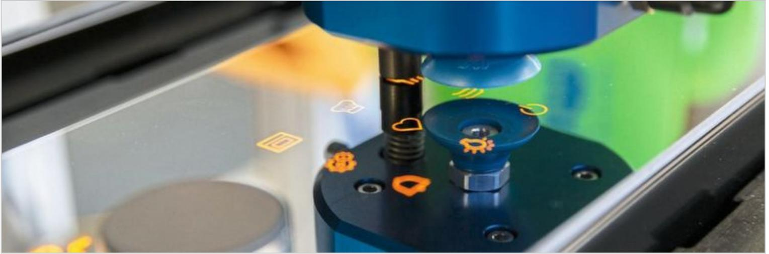
Ein kollaborativer Fanuc-Roboter übernimmt mit einem Touchfinger die Prüfung der Tasten und des Drehknopfs. (Fanuc)
